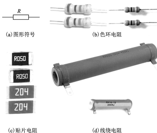
图 1-2 普通电阻的图形符号及实物
