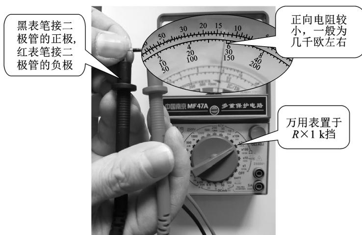
图 1-31 二极管正向电阻测量示意图
