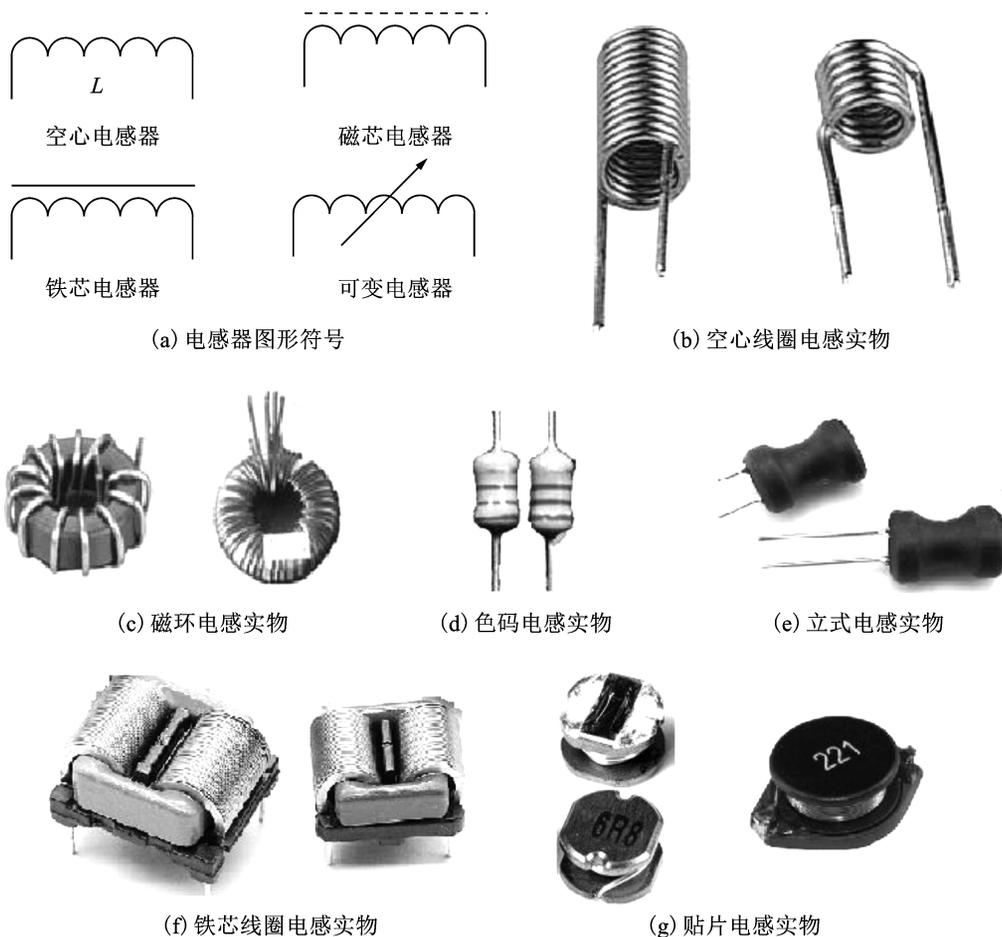
图 1-15 电感器图形符号及实物
