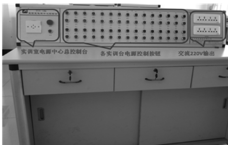
(c) 电源中心总控制台
