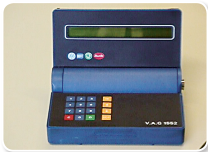
图 1-1-23 大众 VAG1552 诊断仪
