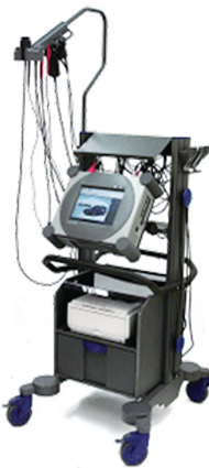
图 1-1-24 大众 VAG5051 诊断仪
