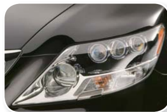
图 1-82 雷克萨斯LS600h的LED前照灯
