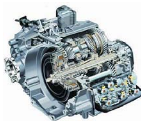
图 1-62 得到迅速发展的双离合变速器
