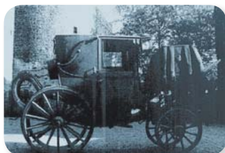
图 1-3 单排座马车由 C 形钢板弹簧减振
