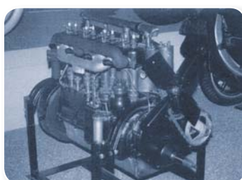
图 1-76 查尔斯·凯特林的电池点火发动机
