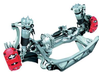
图 1-72 空气弹簧可变式悬架
