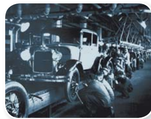
图 1-24 福特的第一条流水线
