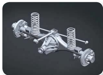
图 1-70 后螺旋弹簧悬架
