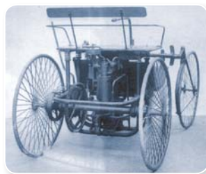
图 1-48 戴姆勒汽车上的 钢轮箍制动装置
