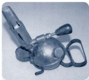
图 1-74 热管式点火装置
