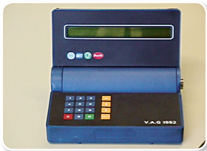
图 1-1-23 大众 VAG1552 诊断仪
