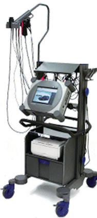
图 1-1-24 大众 VAG5051 诊断仪
