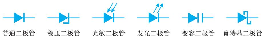
图 1-1-12 常用二极管的图形符号
