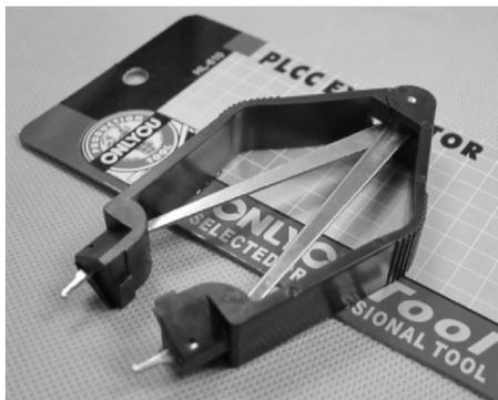
图 1-2-13 IC 起拔器
