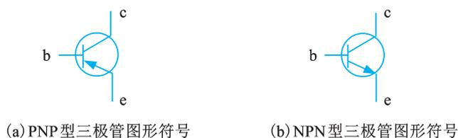
图 1-1-13 三极管的图形符号
