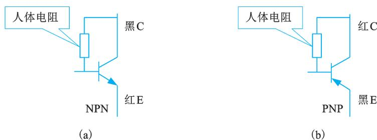
图 1-1-17 三极管集电极、发射极判别
