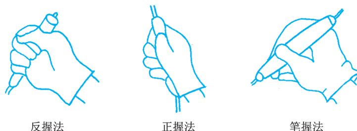
图 1-2-10 电烙铁的握法
