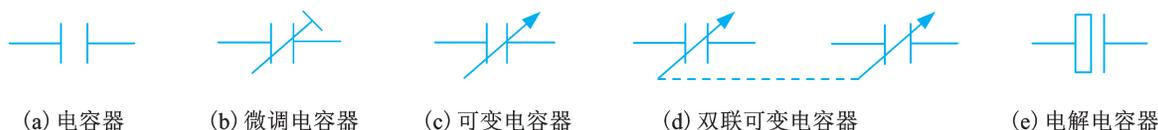
图 1-1-7 电容器的图形符号
