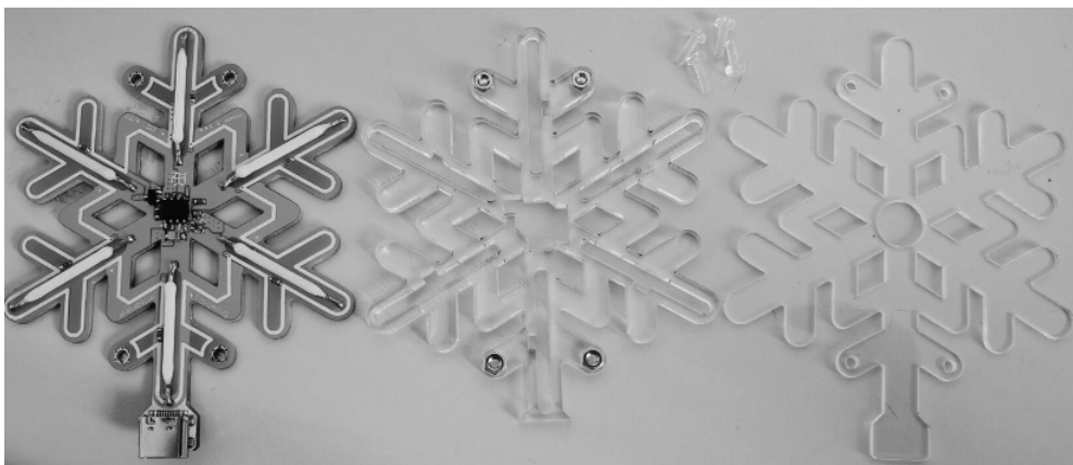
图 1-9 彩色丝印触摸无极调光雪花灯焊接成品及外壳
