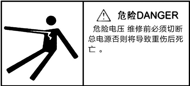
图 1-2 控制柜 SRC2 上的安全图标
