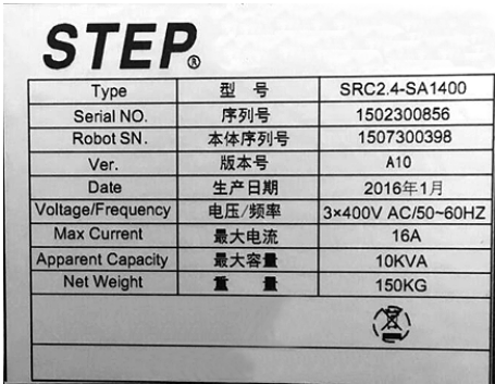
图 1-1 控制柜 SRC2 的铭牌
