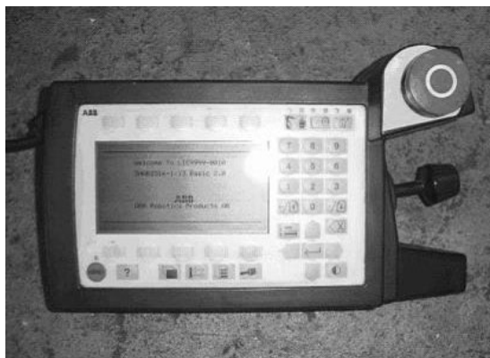
图 1-1-8 ABB 公司的 S4 手持示教器
