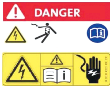
图 1-1-2 车内高压危险区域警示标志
