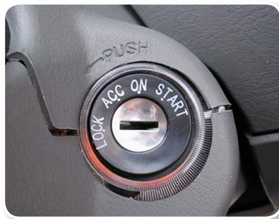
图 1-1-9 开关的表示方法
