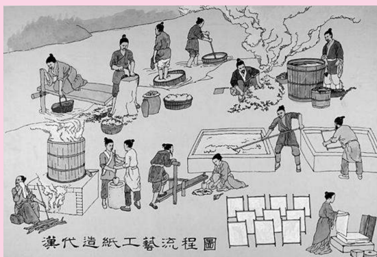
图 1-7 汉代造纸工艺图
