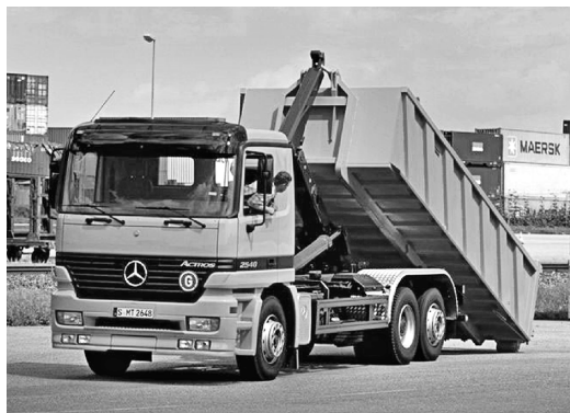
图 1-2 改装后整备质量增加的自卸汽车
