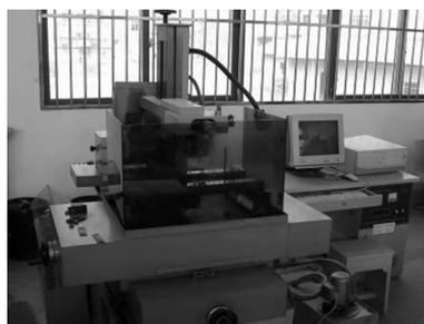
图 1-12 电火花线切割机床
