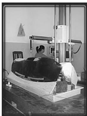
图 1-13 三坐标测量仪
