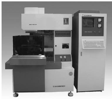
图 1-24 低速走丝线切割机床
