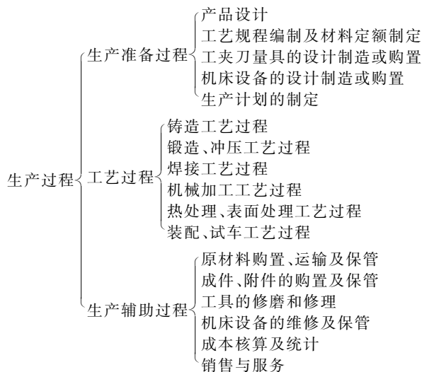
▲图 1-3 生产过程与工艺过程的关系图
