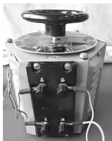
图 1-3-9 单相接触调压器实物图
