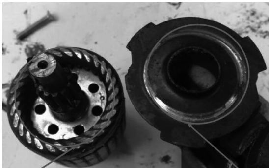
图 1-8 启动机内部的转子和行星齿轮的挡油盘之间严重磨损
