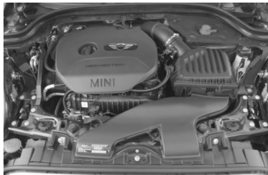
图 1-13 宝马 B38 1.5T 三缸发动机
