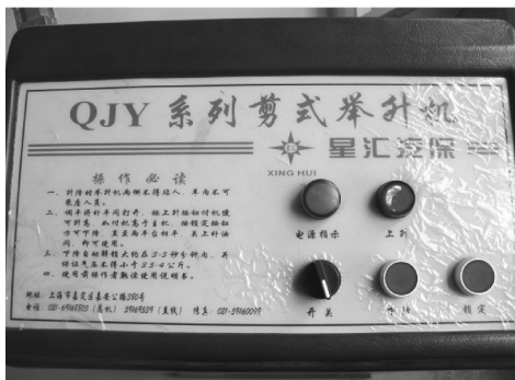
图1-42 控制柜控制面板
