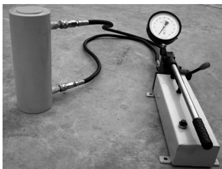
▲图 1-11 手动分离式液压千斤顶
