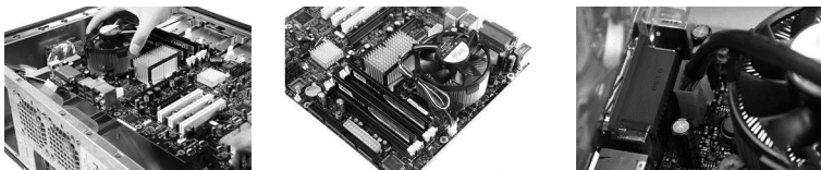
图 1-19 安装 CPU 风扇
