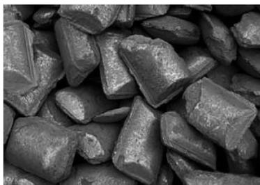
图 1-1-2 炼钢金属料—生铁块
