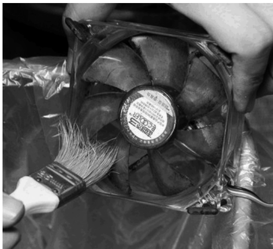
图 1-4-4 清扫 CPU 风扇的灰尘
