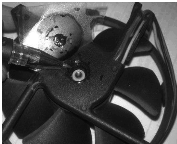
图 1-4-5 给 CPU 风扇加润滑油
