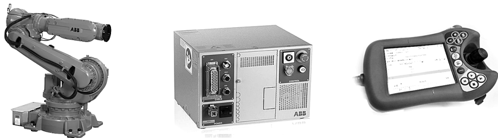
图 1-1 工业机器人系统的基本组成
