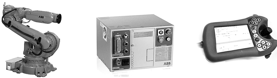
图 1-6 工业机器人系统基本组成的认知
