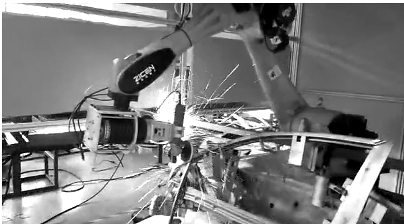
图 1-20 汽车门机器人打磨
