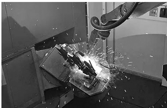
图 1-24 汽车制造中创新型机器人焊接系统
