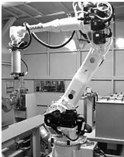
图 1-21 起落架零件打磨
