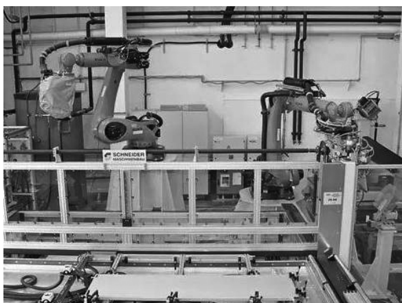
图 1-25 电梯门生产中高度灵活的机器人单元
