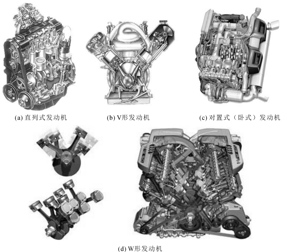
图 1-5 发动机按照气缸排列方式分类
