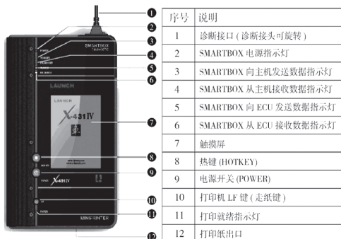
图1-5 X-431解码器的外观和组成
