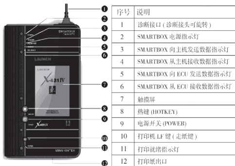
图1-5 X-431的基本结构
