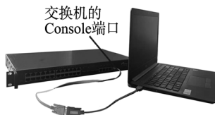
图 3-1 交换机的 Console 端口与计算机的 USB 接口相连
