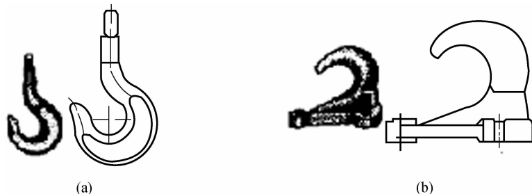
图 1-1 汽车吊钩和托钩的结构 (a)吊钩;(b)托钩
