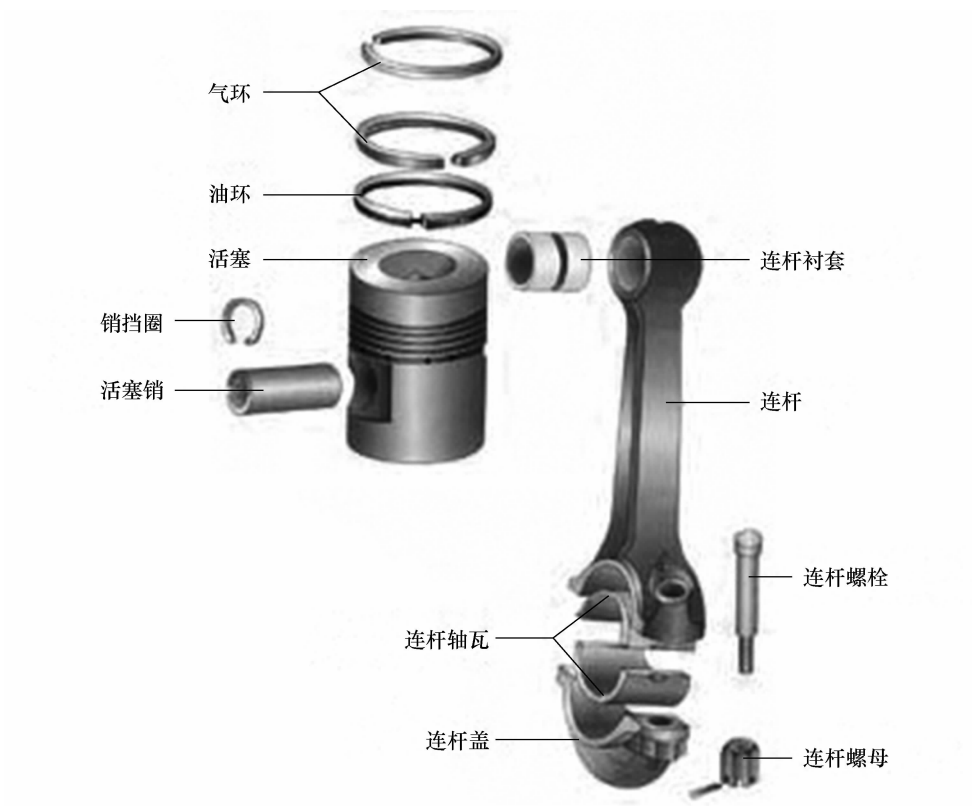
图 2-10 发动机活塞连杆组分解图
