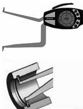
图 2-17 测量连杆小头内径
