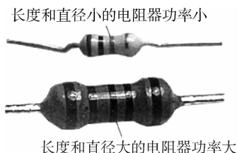
图 1-1-9 根据长度和直径来判别功率大小
