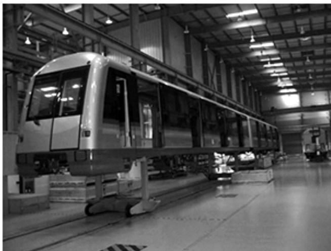
图 1-2 城市轨道交通车辆车体
